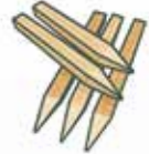
Estacas para demarcação
